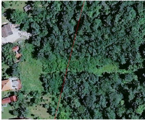
SLIKA 9 Ugroženost 10kV voda rastinjem postojeći ortofoto iz 2011.godine i finalni ortofoto 2016.godine Snimanje priobalnih područja – ugroženost EE objekata od poplava
