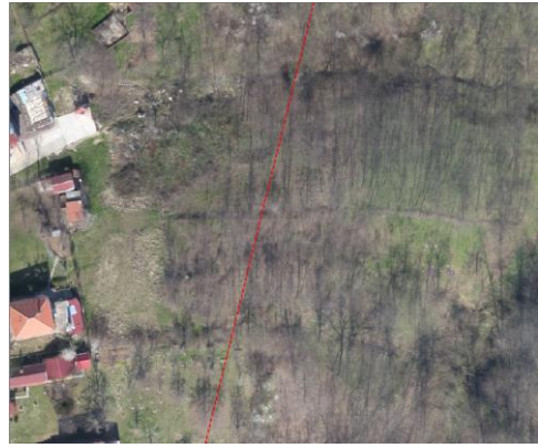
SLIKA 9 Ugroženost 10kV voda rastinjem postojeći ortofoto iz 2011.godine i finalni ortofoto 2016.godine Snimanje priobalnih područja – ugroženost EE objekata od poplava
